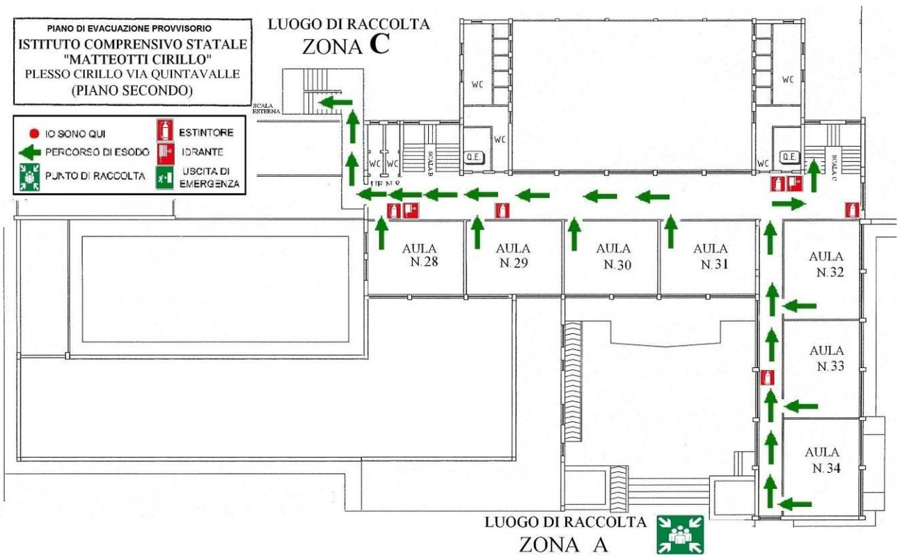
In tutto l'edificio non esistono percorsi protetti, a prova di fumo.
